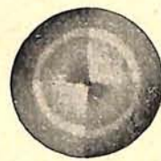
Abb. 17. Darstellung eines Tropfens in der ersten Hauptlage bei der Betrachtung im polarisierten Lichte nach Lehmann.
