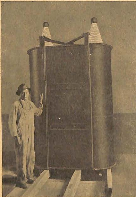
Abb. 1. Hochspannungs-Transformator von 100 000 Volt. Der Hochspannungs-Transformator von 100 000 Volt Spannung (Abb. 1)
