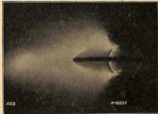
Abb. 11. Brüches Terrella mit Elektronentorus nach Einschaltung des „Ringstromes“.
