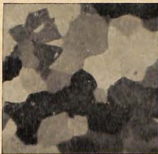
Abb. 6. Elektronenoptische Kristallaufnahme während des Glühens von Platin-Rhodium.
